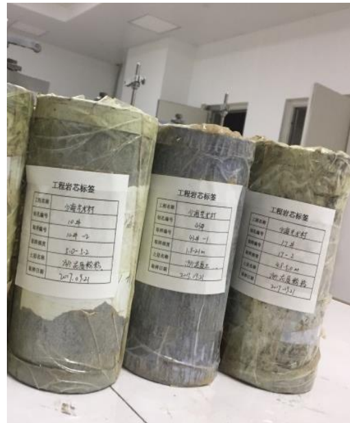
图 6-6 淤泥质原状土样包装及现运输道路情况
