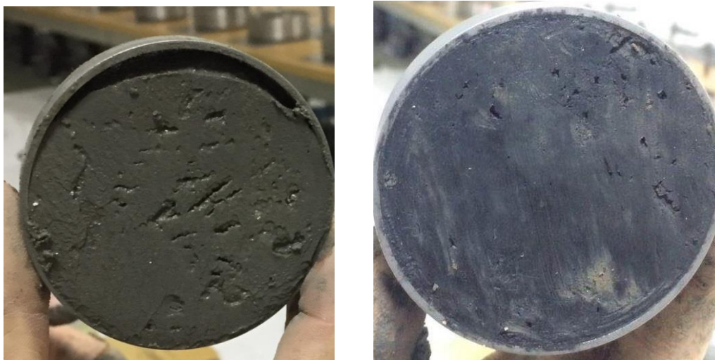
图 6-4 环刀样（脱环、有砂砾导致的缺陷）图
