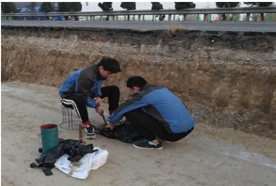
对台阶土改良后进行压实度检测
